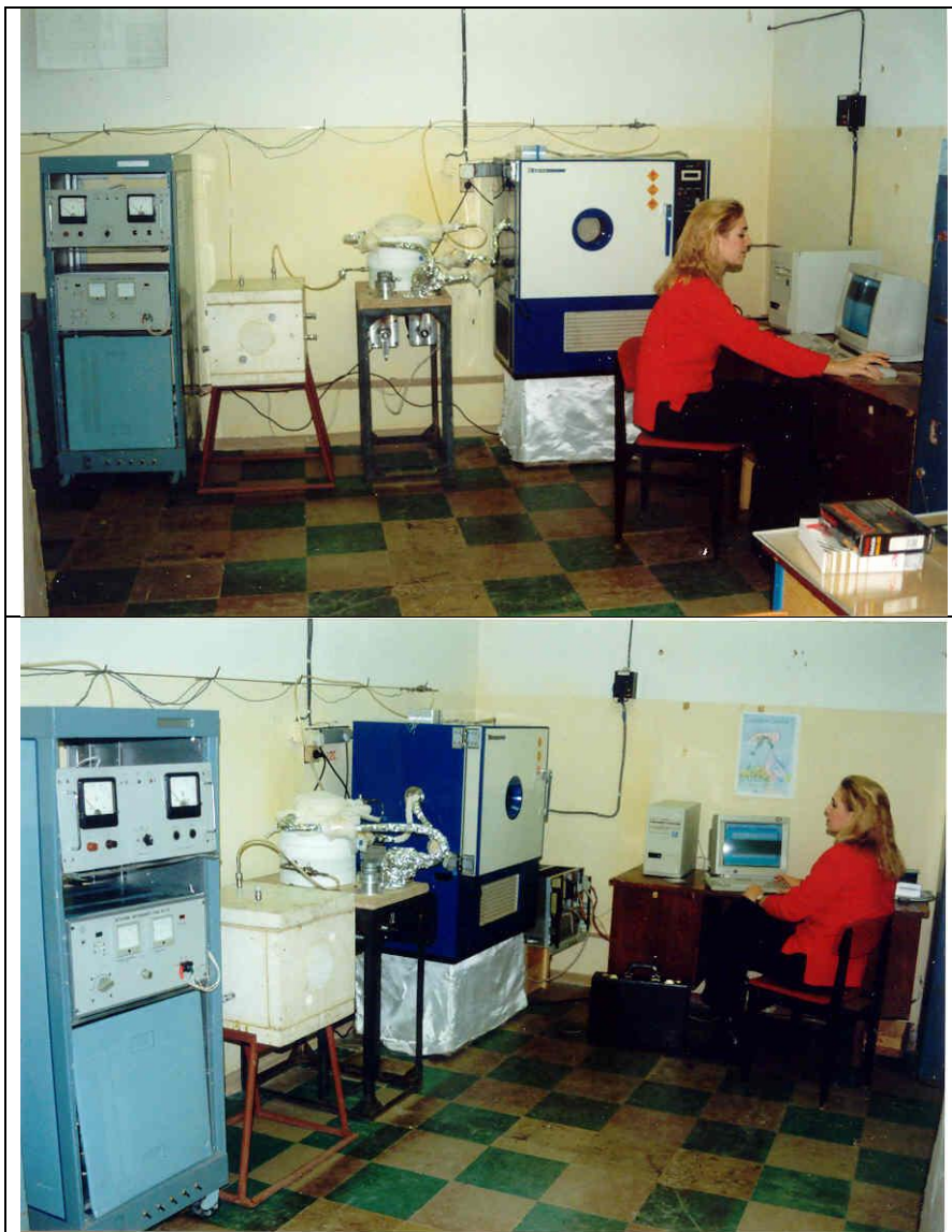
Рис.27. Генератор бинарного льда в закольцованном потоке
