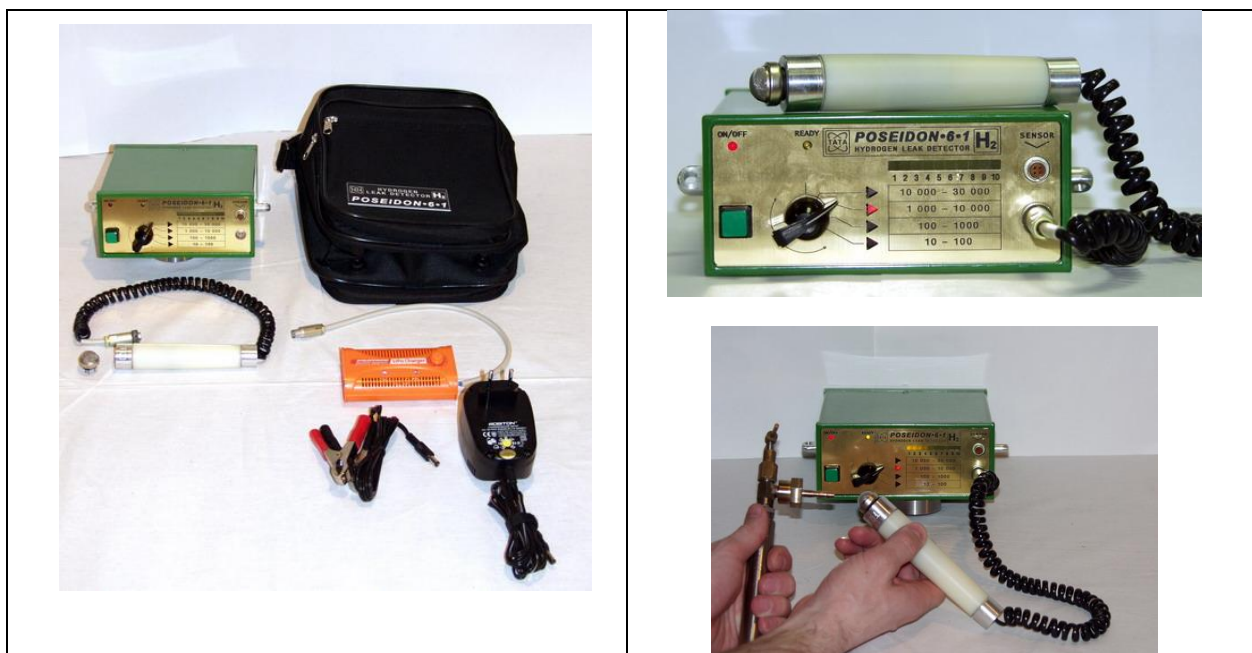
Рис. 4а Разработанные автором с коллегами модели автономных газоанализаторов концентрации водорода и течеискатели, которые могут успешно применяться при определении концентрации водорода в полевых условиях (ООО НТЦ «ТАТА»)
