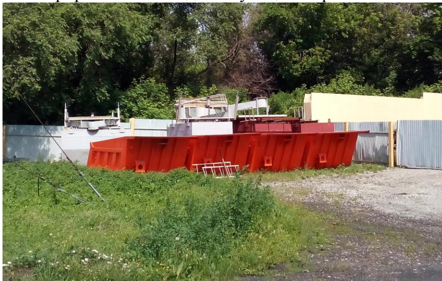
Рис. 3. Заиловочный комплекс на шахте им. С.М. Кирова (емкости – кузова большегрузных автомашин для приготовления глинистой пульпы)
