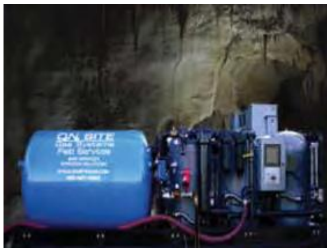
Рис. 4. Компактный адсорбционный генератор азота для работы внутри шахты
