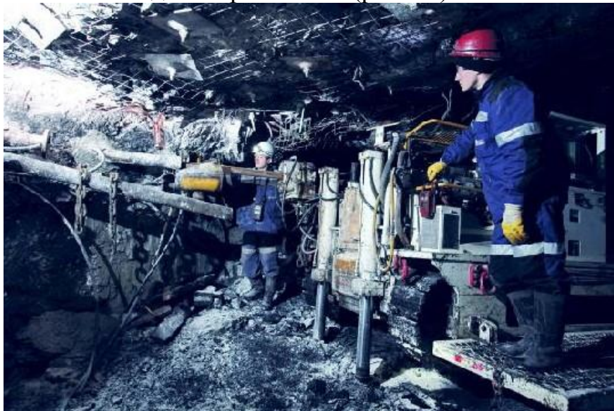
Рис. 11. Буровая установка с системой ориентирования в пространстве VLD 1000А (Австралия)
