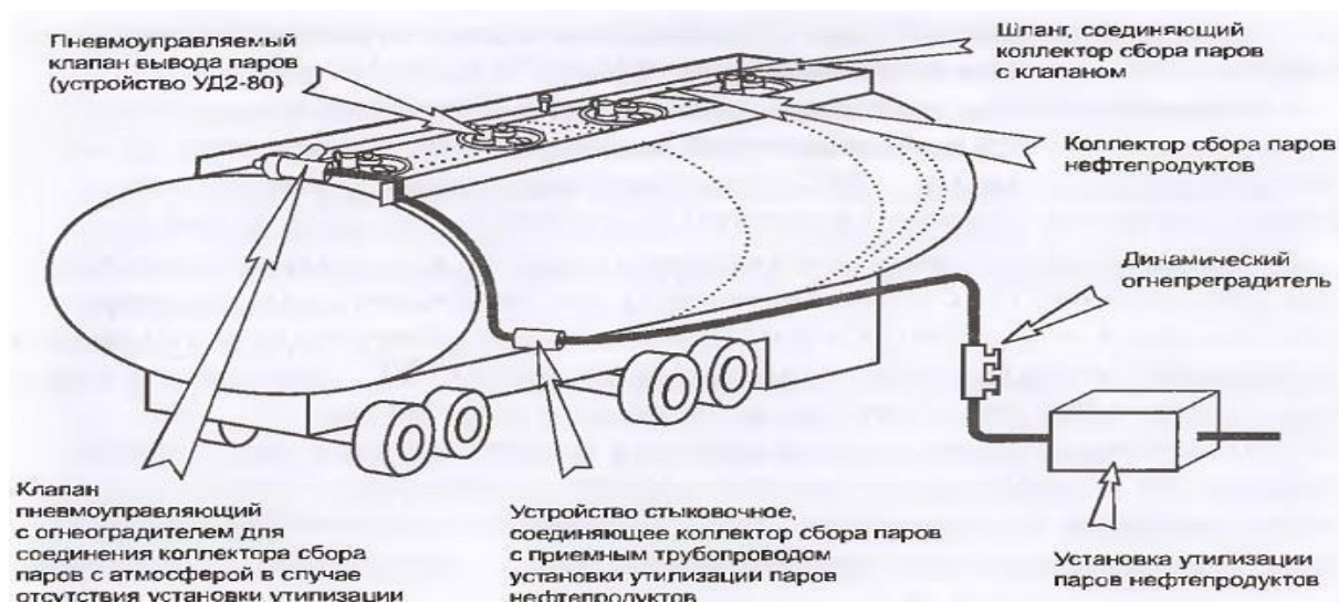
Рисунок 3 - Схема улавливания паров при наливе (сливе) нефтепродуктов из автоцистерн
