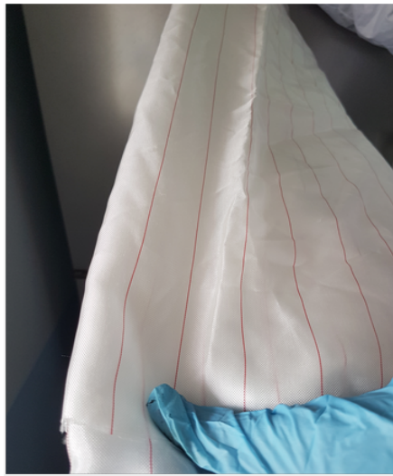
Рис. 2.6. Полиэфирная жертвенная ткань Peel Ply
