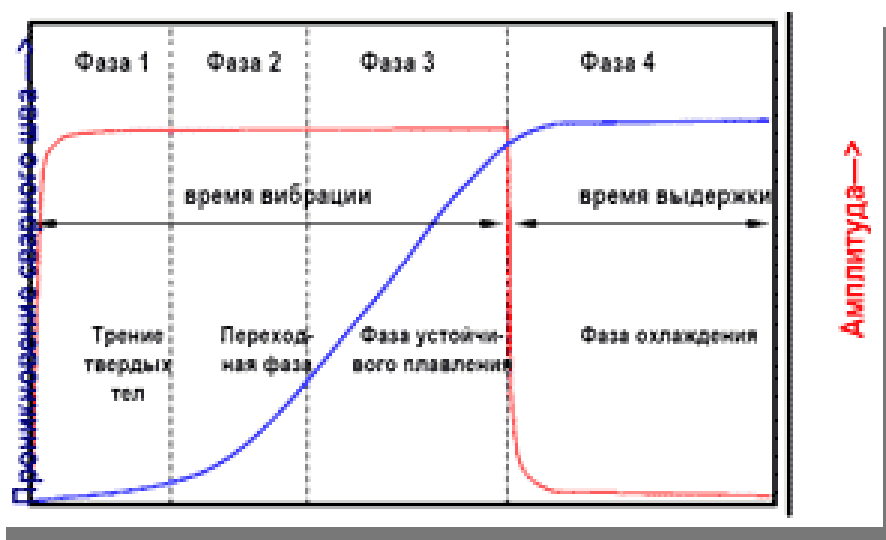
Рис. 1.10. Схематическое изображение хода процесса вибрационной сварки [21]
