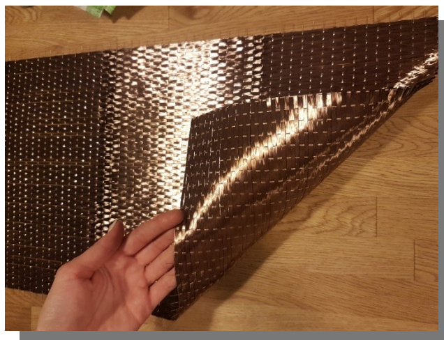
Рис. 2.1. Углеродная лента FibArm Tape-230/300 с напылением меди
