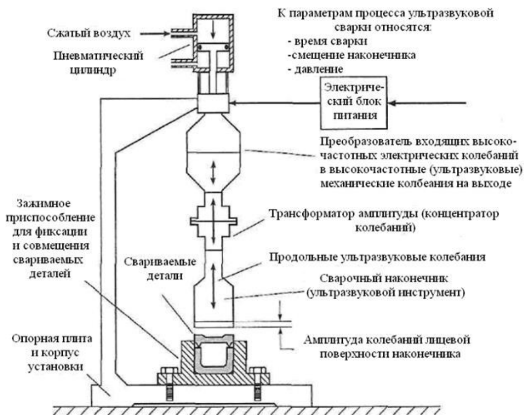
Рис.1.9 Установка для ультразвуковой сварки [19]
