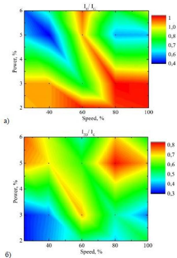
*Рисунок 2. Соотношения интенсивностей пиков  $I_D/I_G$  (а) и  $I_{2D}/I_G$  (б) от мощности лазера и скорости движения лазера*
