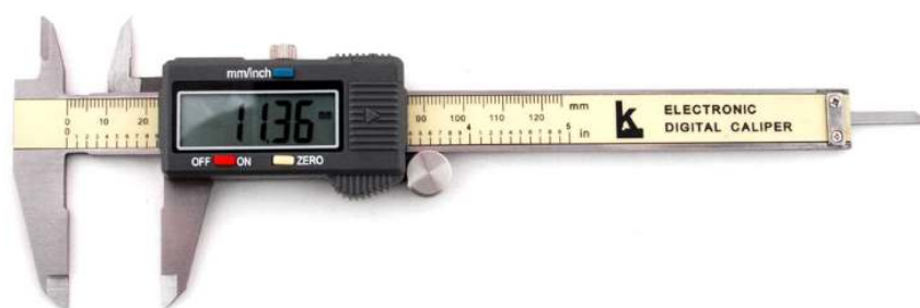
Рисунок 6. Цифровой электронный штангенциркуль [16]
