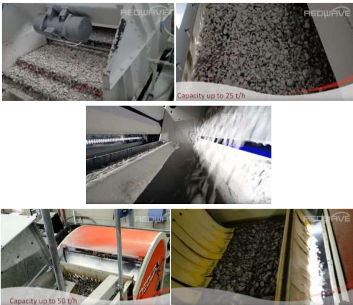
Рисунок 18 – Движение рудного материала по конвейерной ленте
