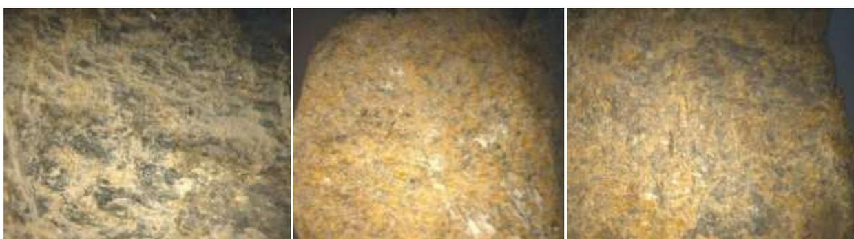
Рисунок 4 - Бесцветные зерна оливина в породе и присутствующие по тонким трещинам гидроокислы железа буровато-коричневого цвета
