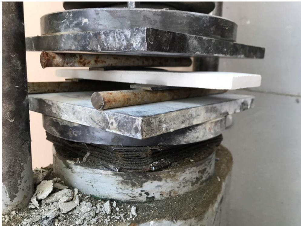
Рисунок 3.2 – Внешний вид гидравлического пресса с образцом перед испытанием
