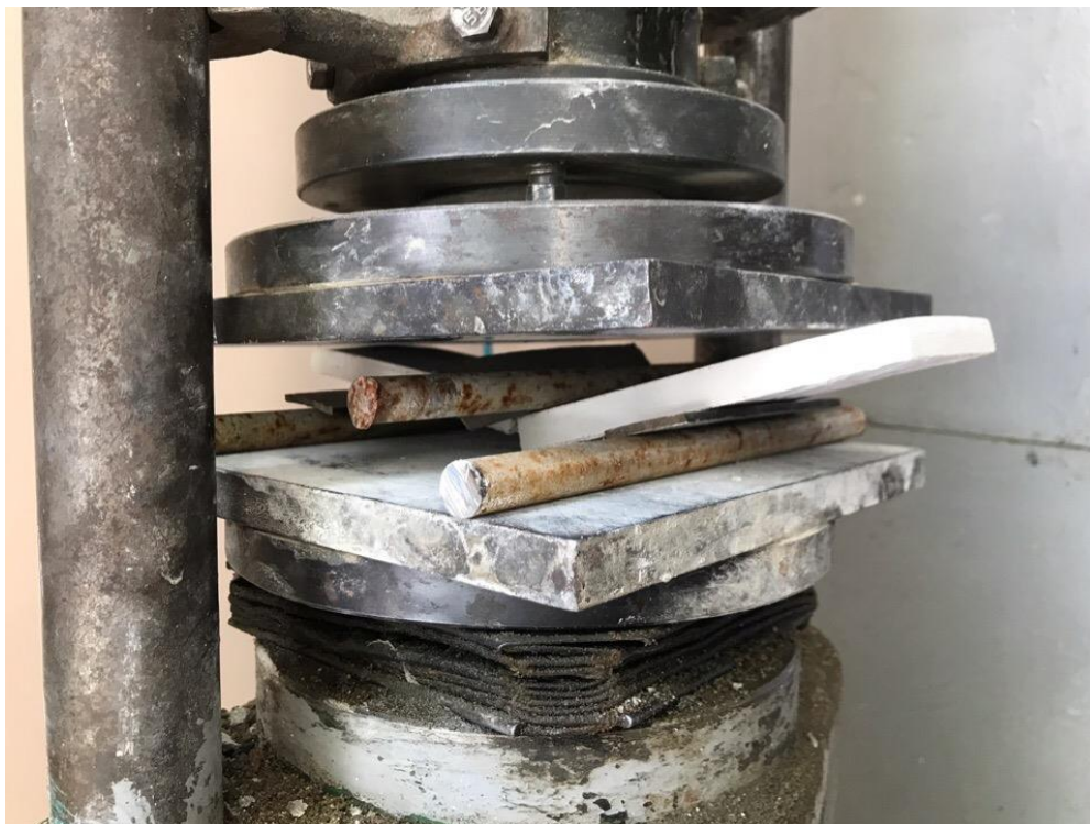
Рисунок 3.3 – Внешний вид гидравлического пресса с образцом после приложения разрушающей нагрузки
