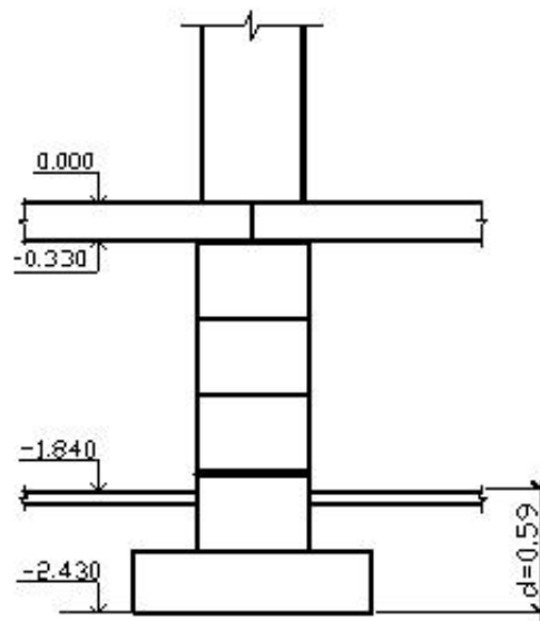
Рисунок 2.10 – Схема конструкции фундамента
