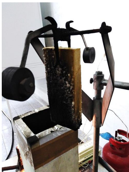
Рисунок 6 – Остывание образца в установке «Керамическая труба»
