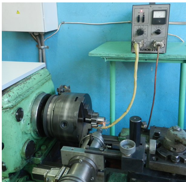
Рисунок 5.2 – Наплавка цапф шестерен с использованием комплекса БИГ-3
