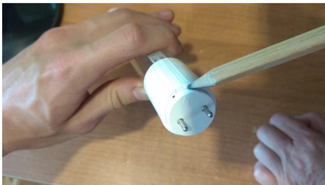
Рисунок 3.15 – Нанесение клея на цоколь
