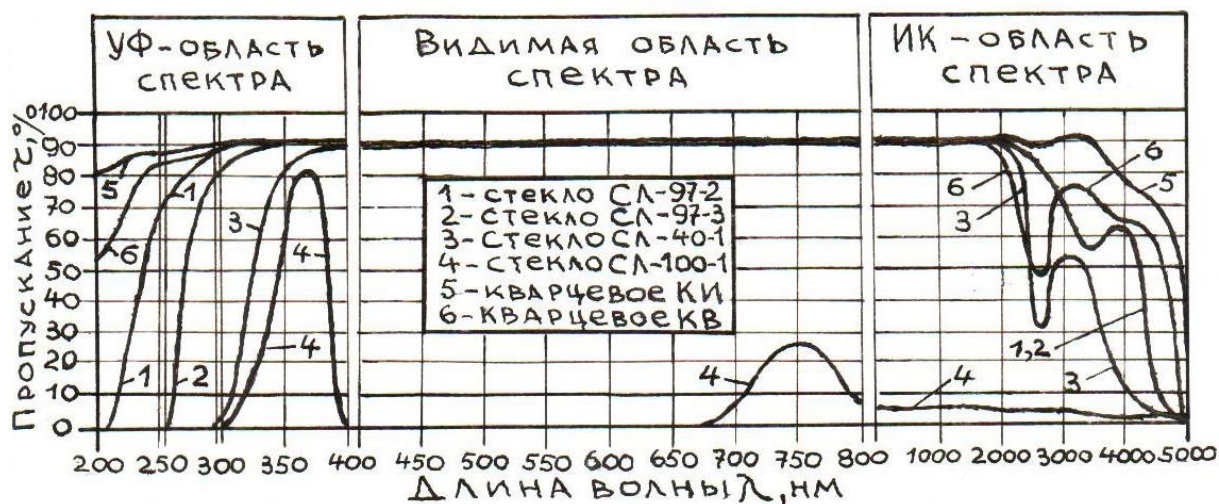
Рисунок 3.1 – Спектры пропускания некоторых электроламповых стёкол в УФ-, видимой и ИК-диапазонах спектра (толщина образцов 1 мм)
