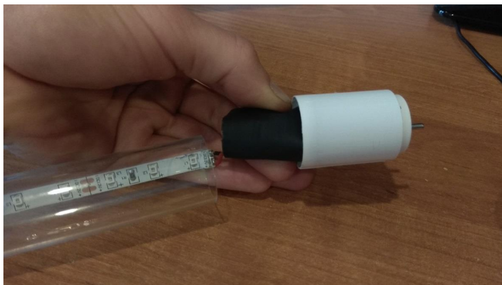
Рисунок 3.14 – Расположение драйвера в термоусадочной трубке
