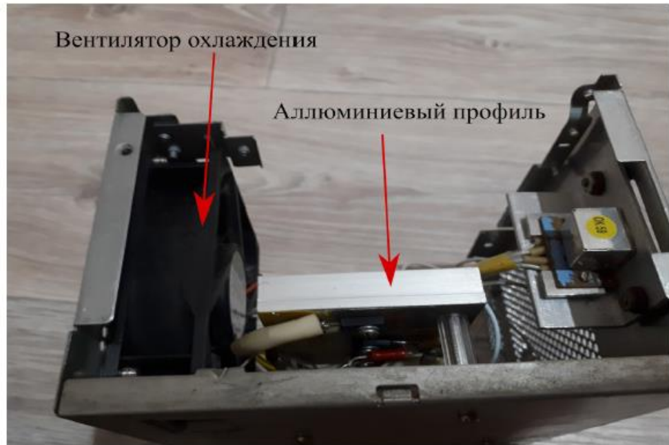
Рисунок 10 – Активная система охлаждения блока усиления
