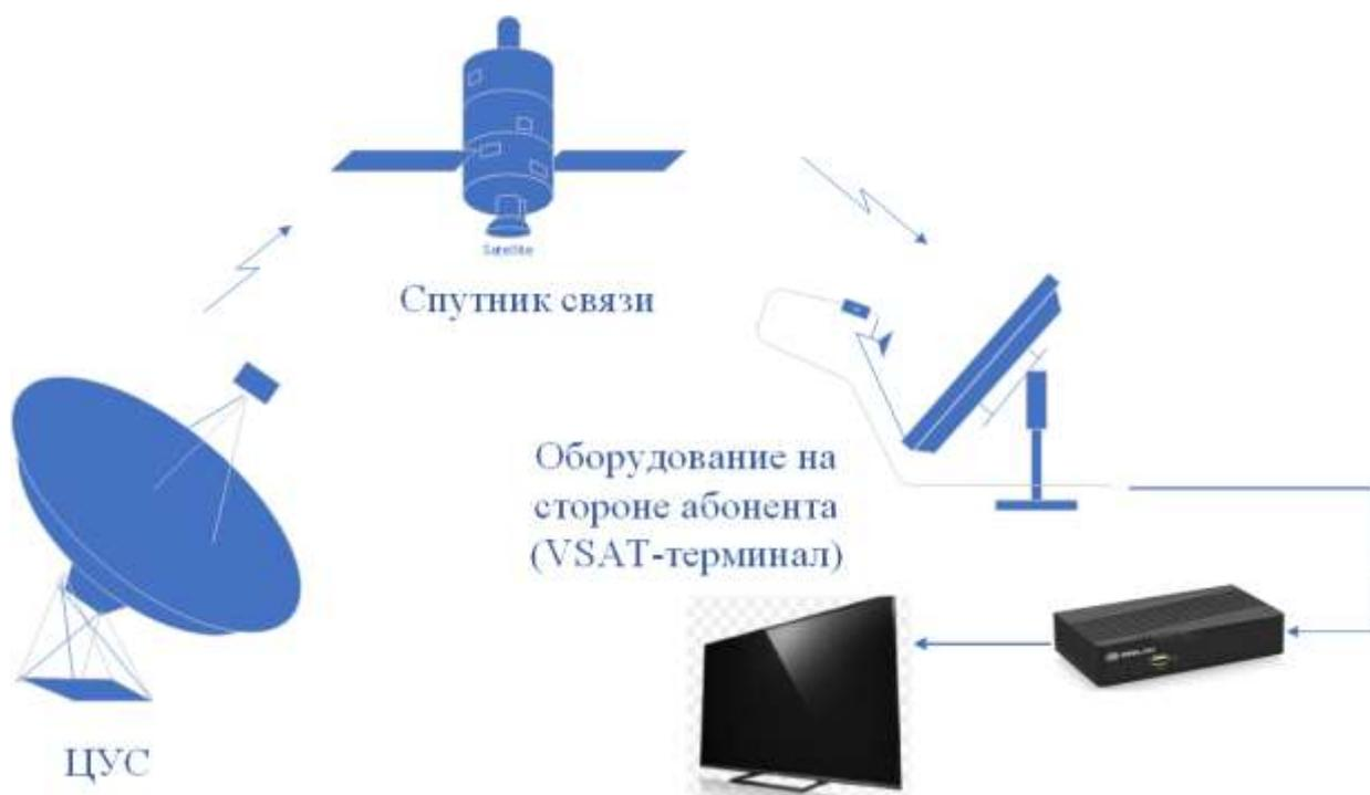
Рисунок 5 – Организация спутниковой связи VSAT
