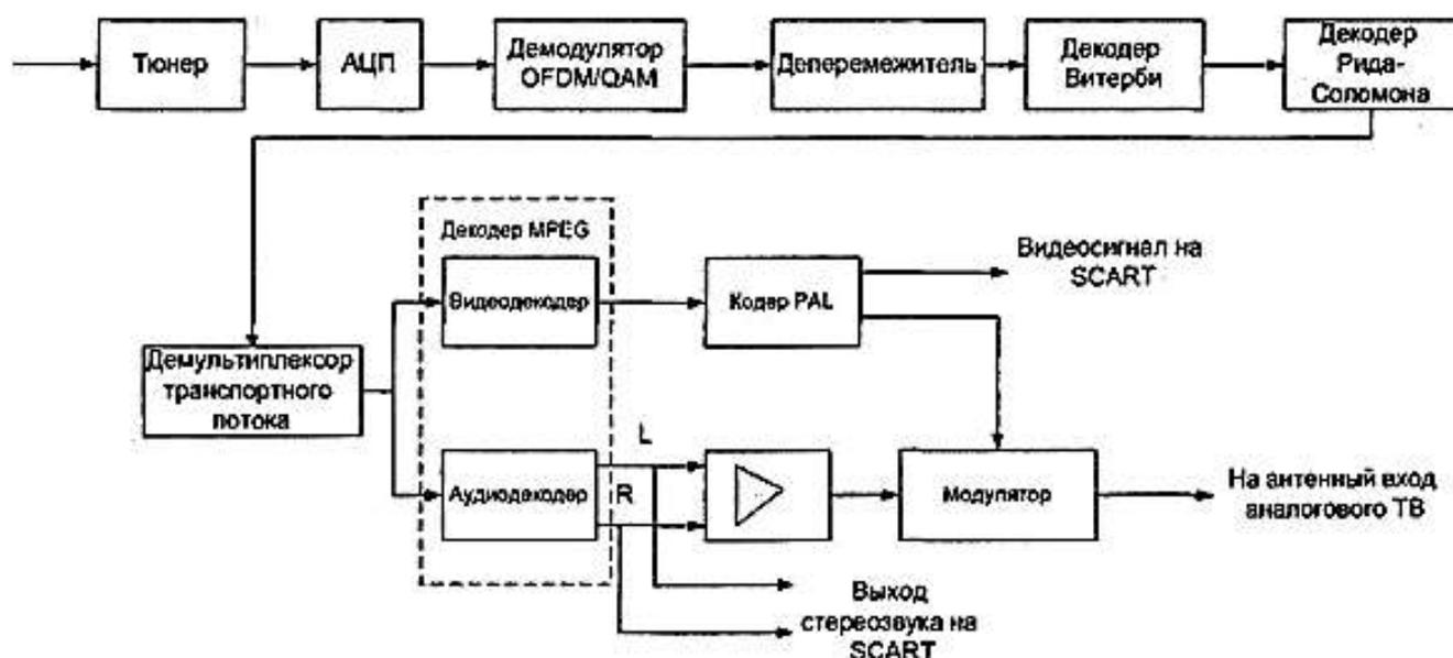
Рисунок 15 – Функциональна схема абонентской приставки
