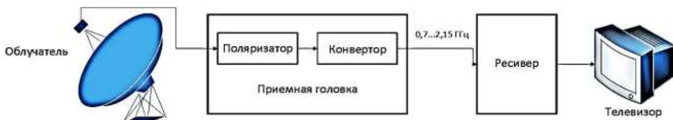
Рисунок 4 – Упрощенная схема приемной установки спутникового телевидения
