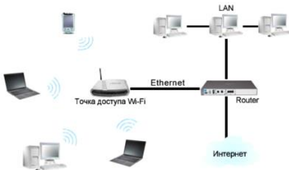
Рисунок 1.2 – Схема организации связи Wi-Fi
