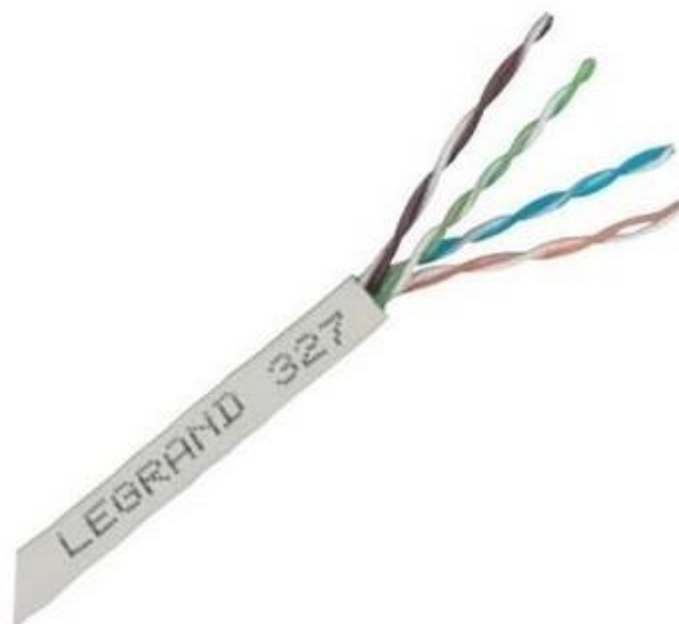
Рисунок 12 – Кабель LCS5 UTP, кат. 5е, 4х2, оболочка LSZH
