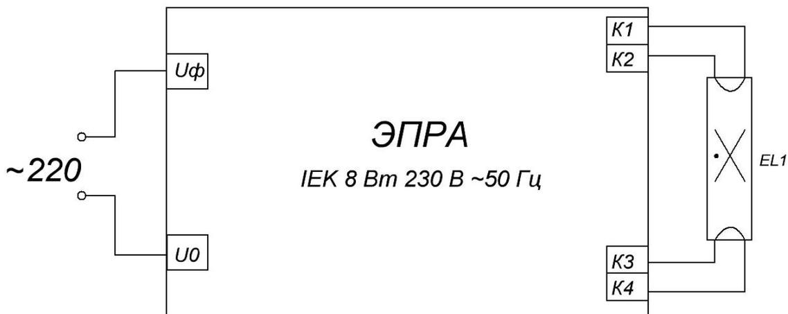
Рисунок 6 — Схема подключения ЭПРА для исследования на электромагнитную совместимость
