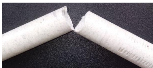
Рисунок 2 – Внешний вид образцов ЦПК после испытаний на разрыв.
