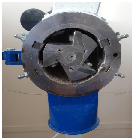
Рисунок 2.1 – Внешний вид ножевой мельницы РМ 120 и камеры с ротором, решеткой, режущими ножами и контрножами
