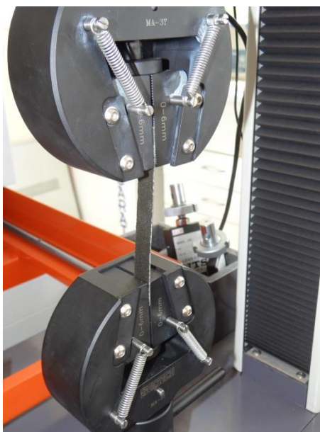
Рисунок 2.7 – Внешний вид захватов машины при испытаниях образцов на растяжение
