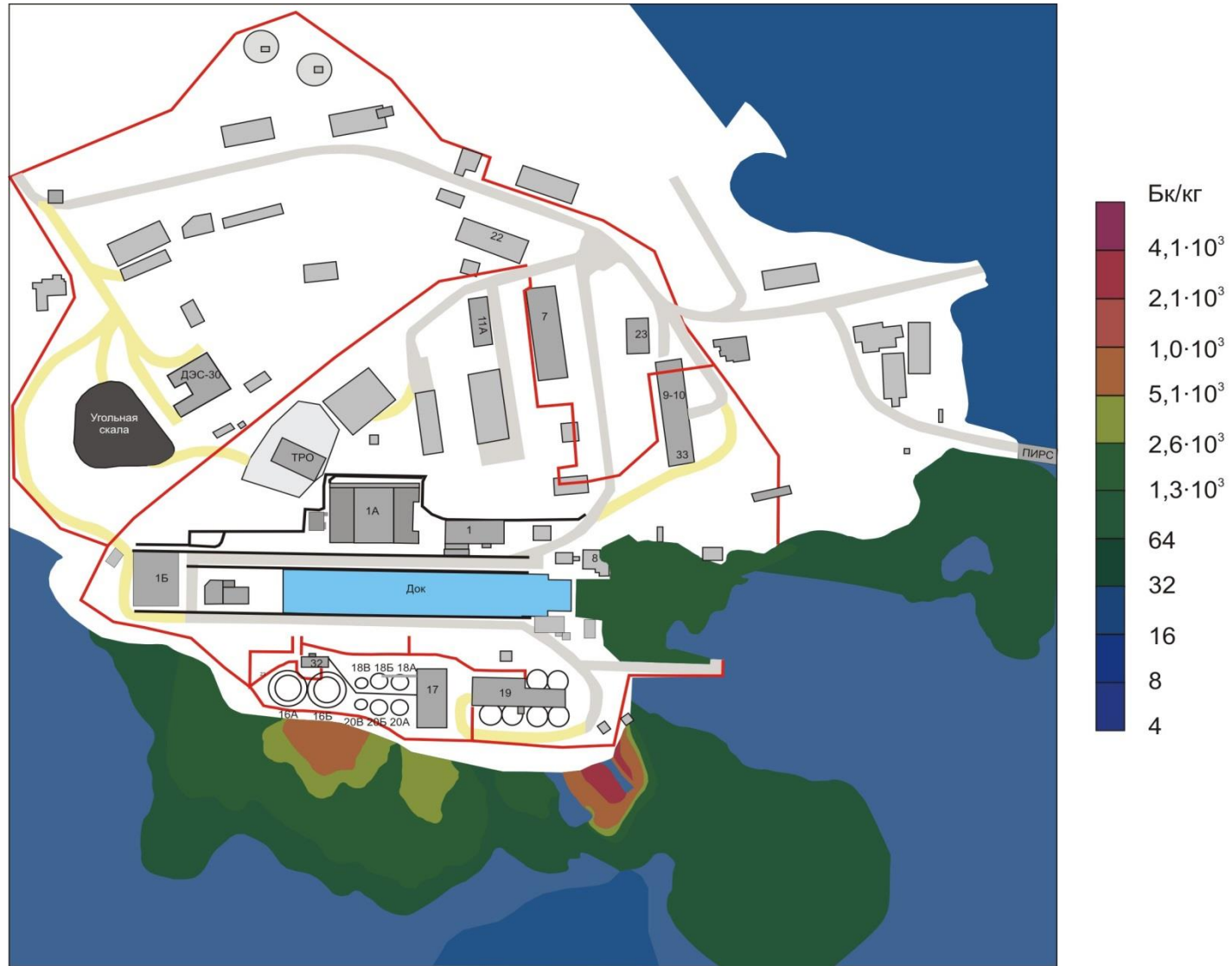
Рисунок 6 – Схема распределения техногенных радионуклидов Cs-137 в донных отложениях прибрежной акватории ПВХ (2017 г.). Отделение Гремиха [22]
