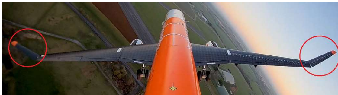
Рисунок 1.16 – Испытательный полёт модели самолёта A321 с отклоняющимися законцовками
