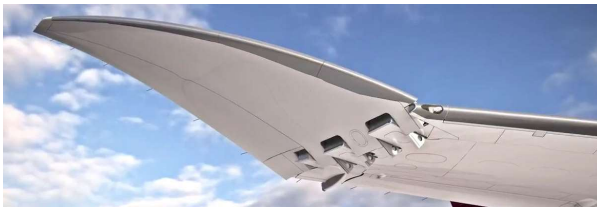
Рисунок 1.17 – Отклоняющаяся КАП, установленная на Boeing 777X
