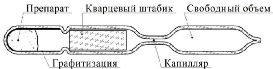
Рис. 1.8. Схема ампулы для определения давления пара весовым методом Джугетта [32].
