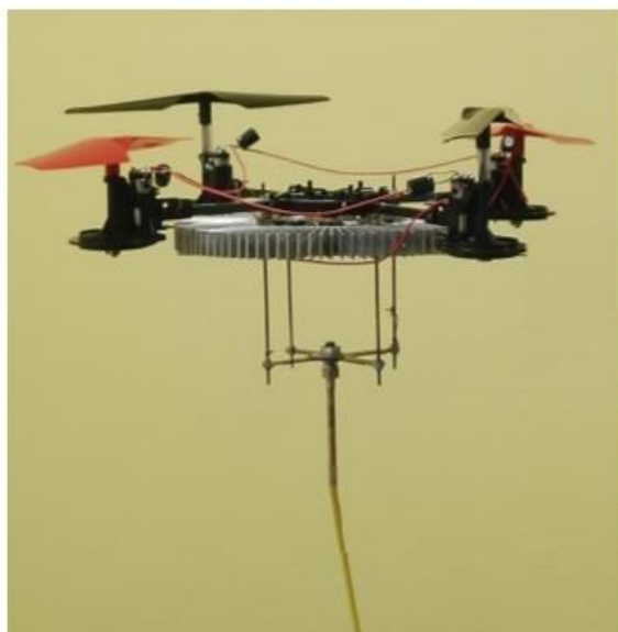
Рис. 1.6. Квадрокоптер со смонтированным на нем фотопреобразователем и оптическим кабелем
