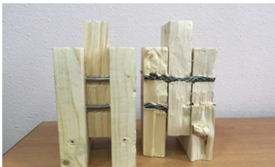
Рисунок 3.8 – Характер разрушения образцов:
