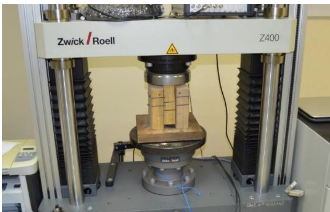
Рисунок 3.12 – Образец в испытательной машине Zwick Z400E
