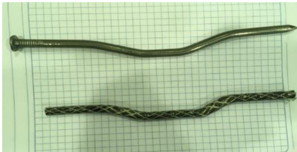
Рисунок 3.11 – Внешний вид нагелей из стали и углепластика после деформирования в образцах с толщиной досок 50 мм
