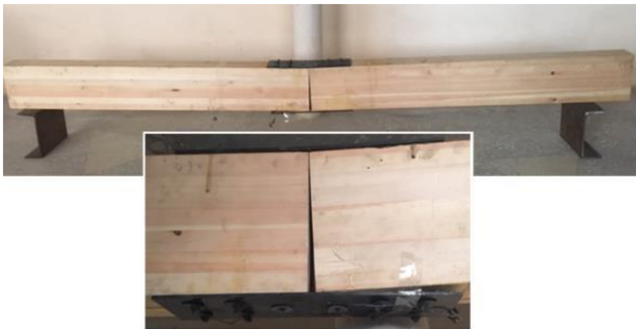
Рисунок 4.17 – Образец после разрушения стыка
