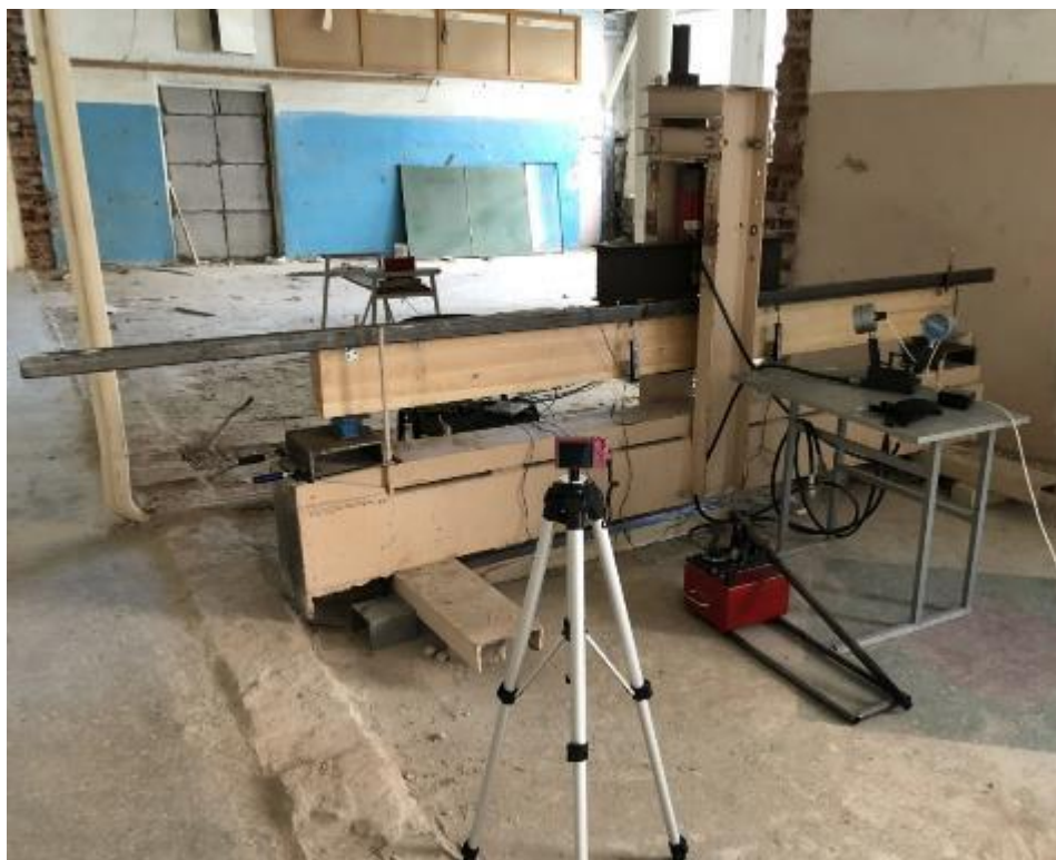
Рисунок 4.16 – Балка на испытательном стенде
