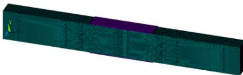
Рисунок 4.20 – Конечно-элементная модель балки со стыком на клеенных стержнях
