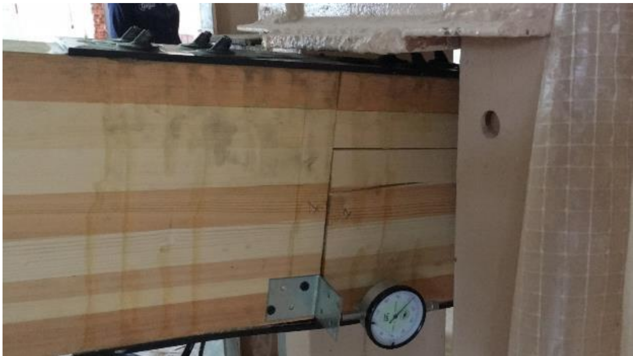
Рисунок 4.27 – Разрушение стыка, образование продольных трещин
