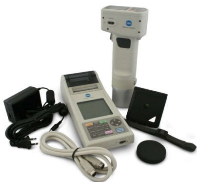
Рисунок 9. Спектрофотометр (колориметр) Chroma meter CR-410
