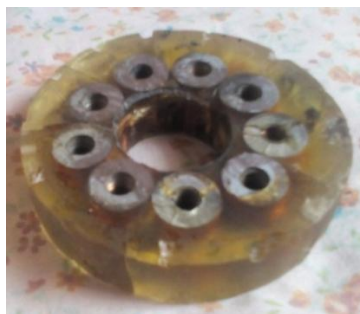
Рисунок 18 – статор со сквозными отверстиями охлаждения.
