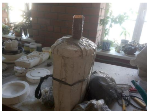
Рис.2.11 Скрепляем форму резинками. Рис.2.12 Устанавливаем литник, заливаем шликер в форму
