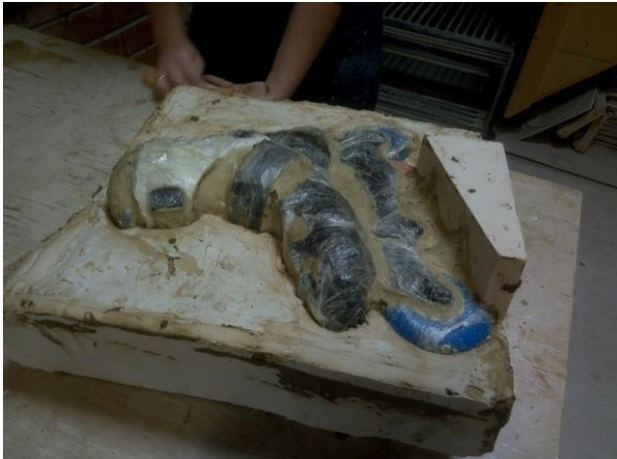
Рис.2.8 Готовая первая часть формы.
