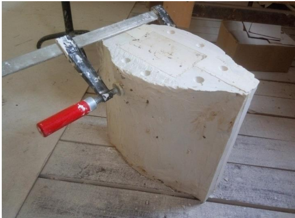
Рис.2.10 Подготовка формы к заливке 3 части гипсовой формы.
