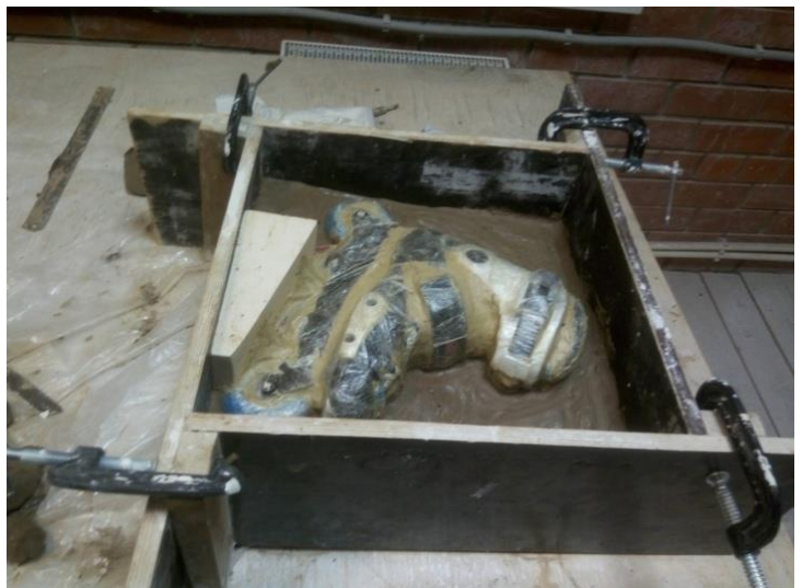
Рис.2.6-2.7 Подготовка модели к изготовлению гипсовой формы, установка опалубки.
