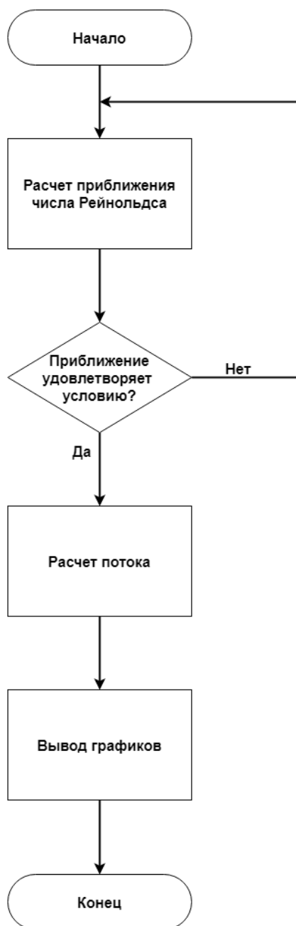
Рисунок 13 – Блок-схема модели по расчету объемного расхода.
