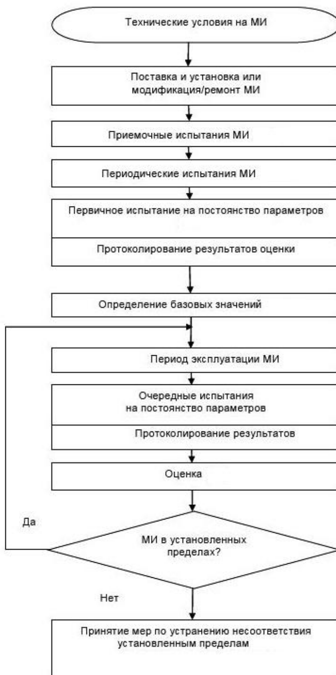
Рисунок 4 – Общая схема проведения контроля
