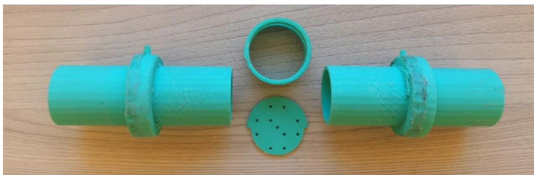
Рисунок 24 – Готовая модель трубки для создания перепада давления
