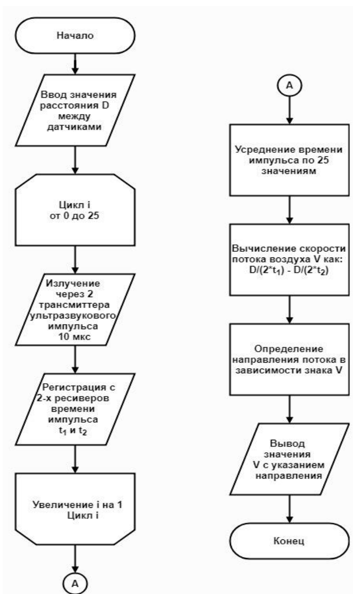
Рисунок 7 – Блок-схема устройства для проверки аппарата ИВЛ основанного на УЗ методе
