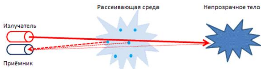
Рисунок 6 – Принцип действия импульсного светодальномера
