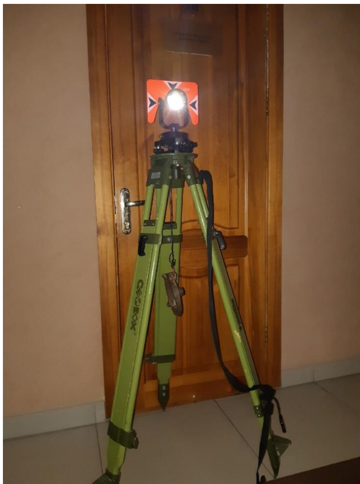
Рисунок 16 – Использование груза для придания штативу большей устойчивости
