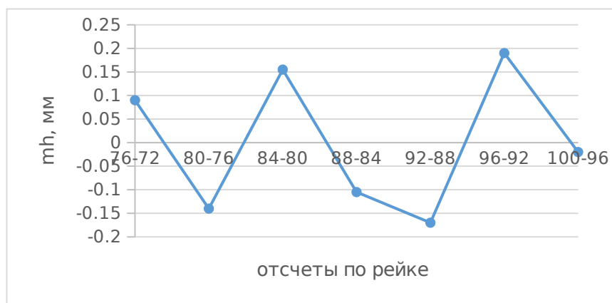
Рисунок 14 – График зависимости точности определения превышения от величины угла наклона (дополнительная шкала)
