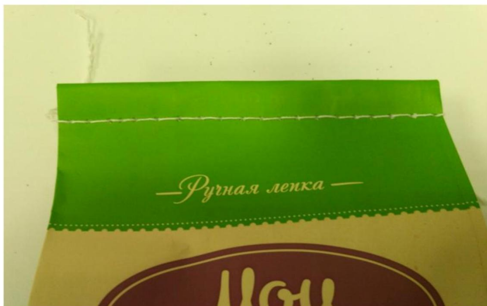
Рис. 1.4 Внешний вид шов строчки – лицевая сторона
