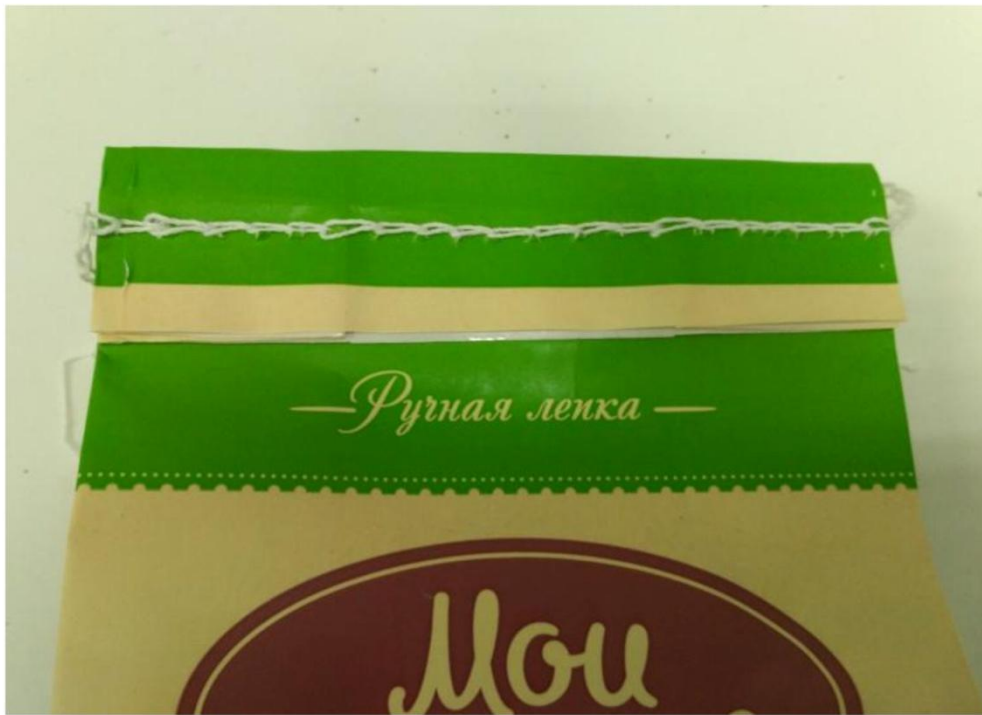
Рис. 1.5 Внешний вид шов строчки обратная сторона (тыльная)
