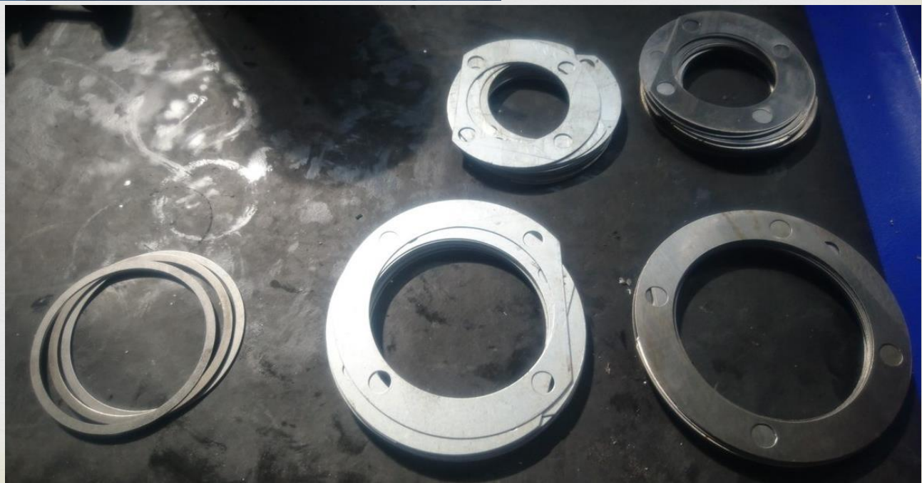
Рис.10. Подгоночные прокладки для устранения зазора между крышкой и подшипником
