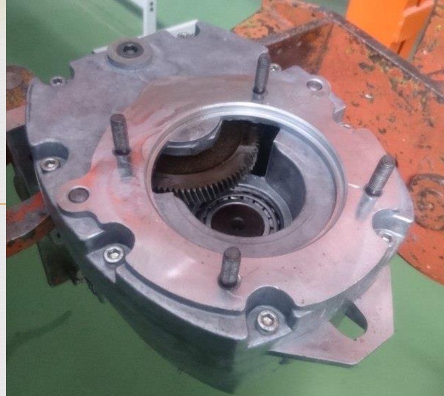
Рис.11. Готовый редуктор со вкрученными шпильками для присоединения мотора
