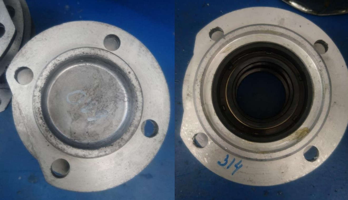
Рис.8-9. Крышки для фиксации промежуточного и выходного валов
