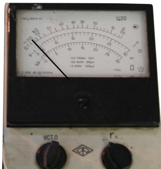
Рисунок 15. Напряжение на контактах электромотора нагнетателя в начальной стадии запуска. Напряжение 2В – начало образования пламени.
