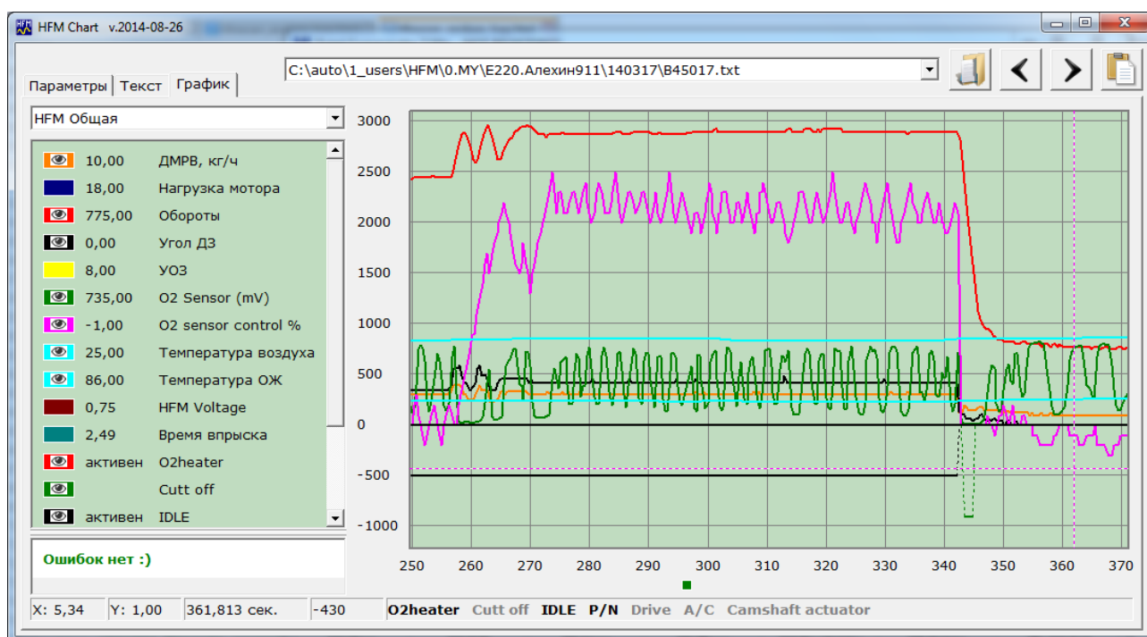
Рисунок 9 – Фрагмент диагностирования автомобиля адаптером ELM327
