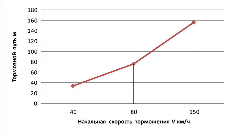
Рисунок 41 – Результат тормозного пути автомобиля «Padjero 4» с колодками «Ate»
