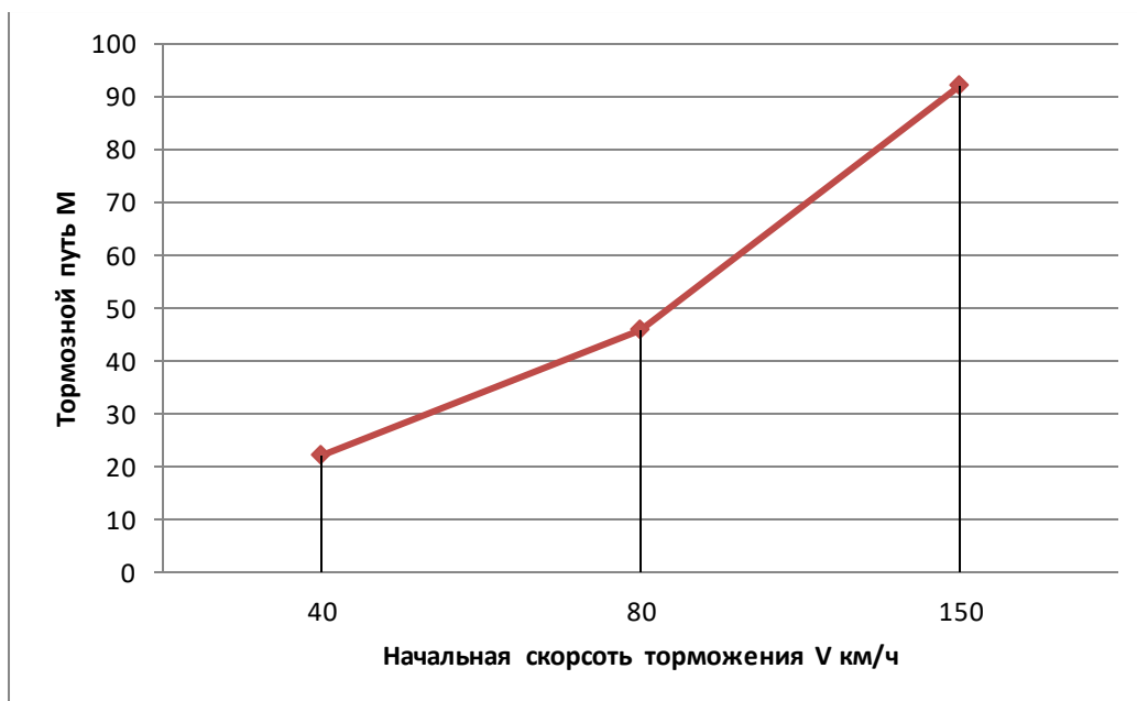
Рисунок 35 – Результат тормозного пути автомобиля «Mercedes – Benz w202» с колодками «Ate»
