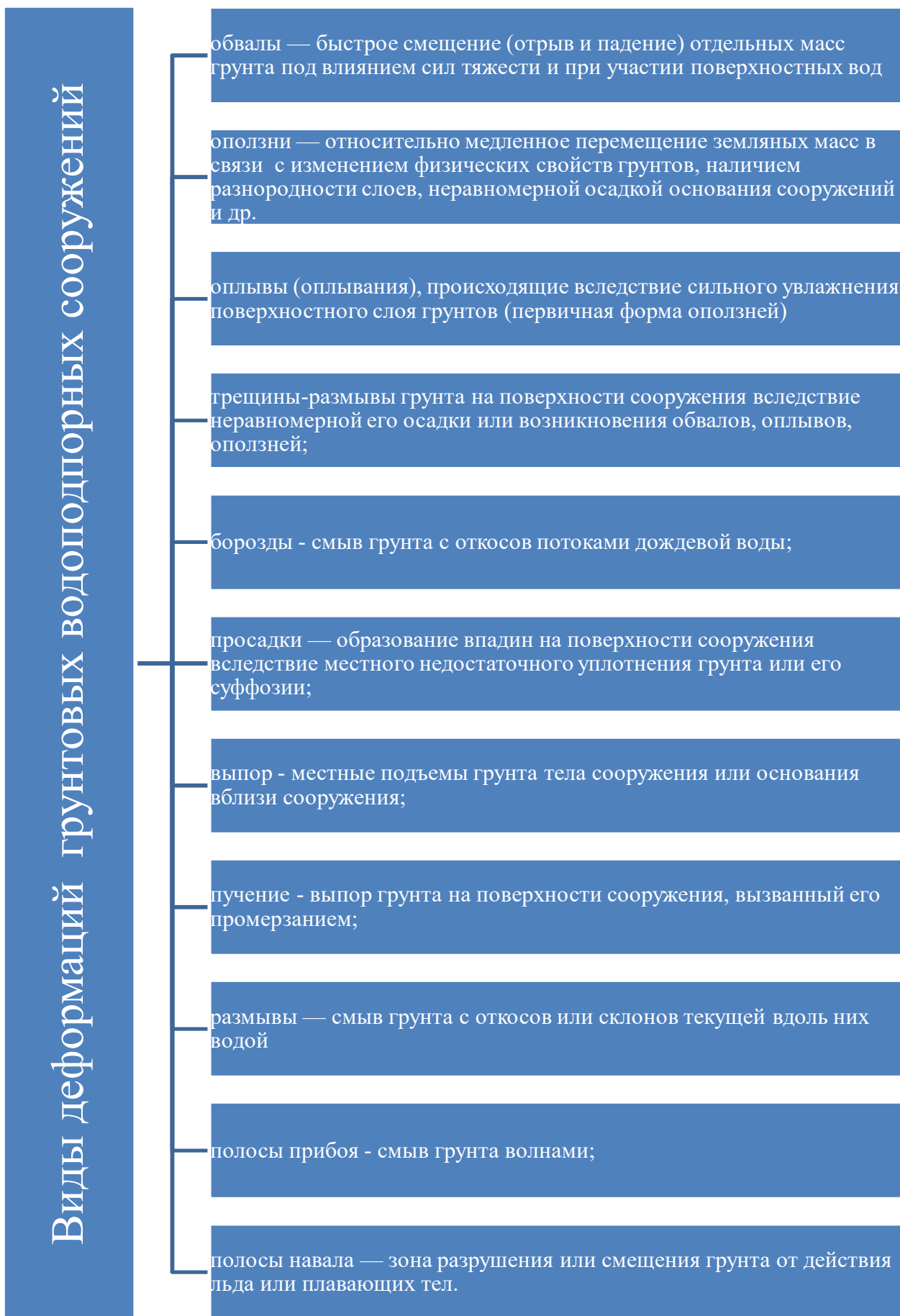
Рисунок 2.5 - Виды деформаций грунтовых водоподпорных сооружений
