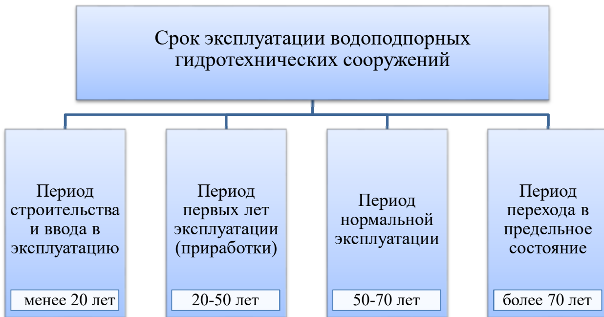
Рисунок 3.3 – Параметры срока эксплуатации водоподпорных ГТС
