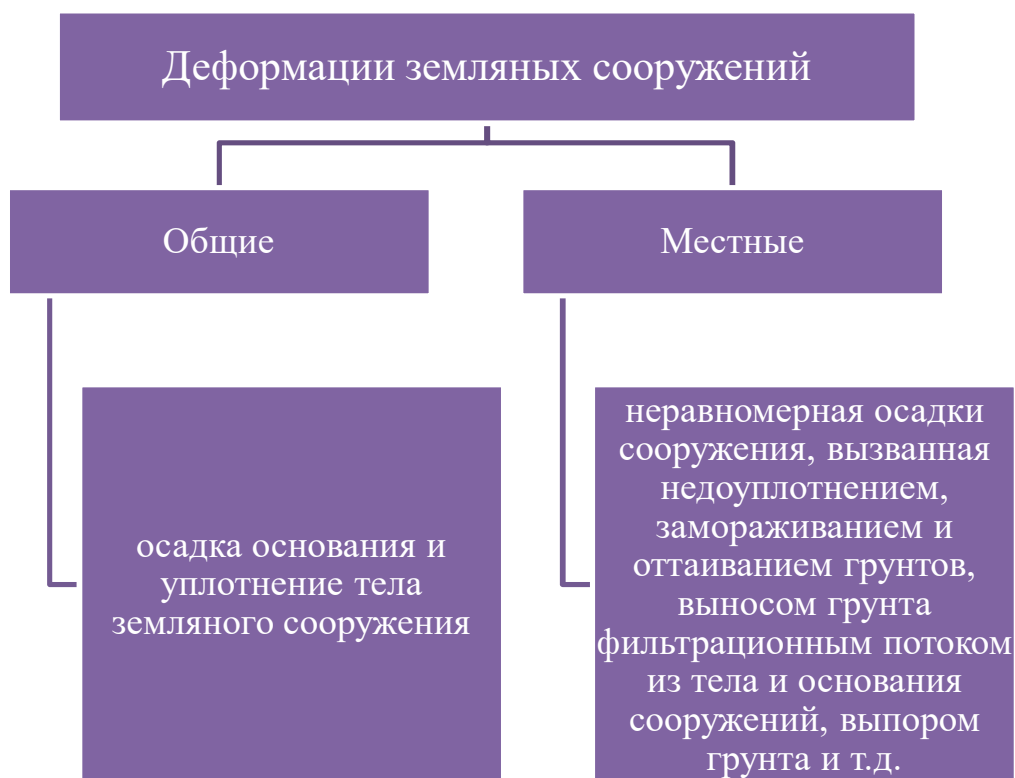
Рисунок 2.12 – Виды деформаций земляных сооружений
