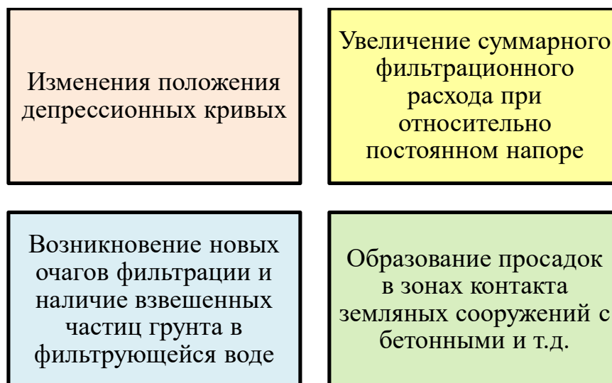
Рисунок 2.15 – Характеристики нарушения режима нормальной эксплуатации сооружений
