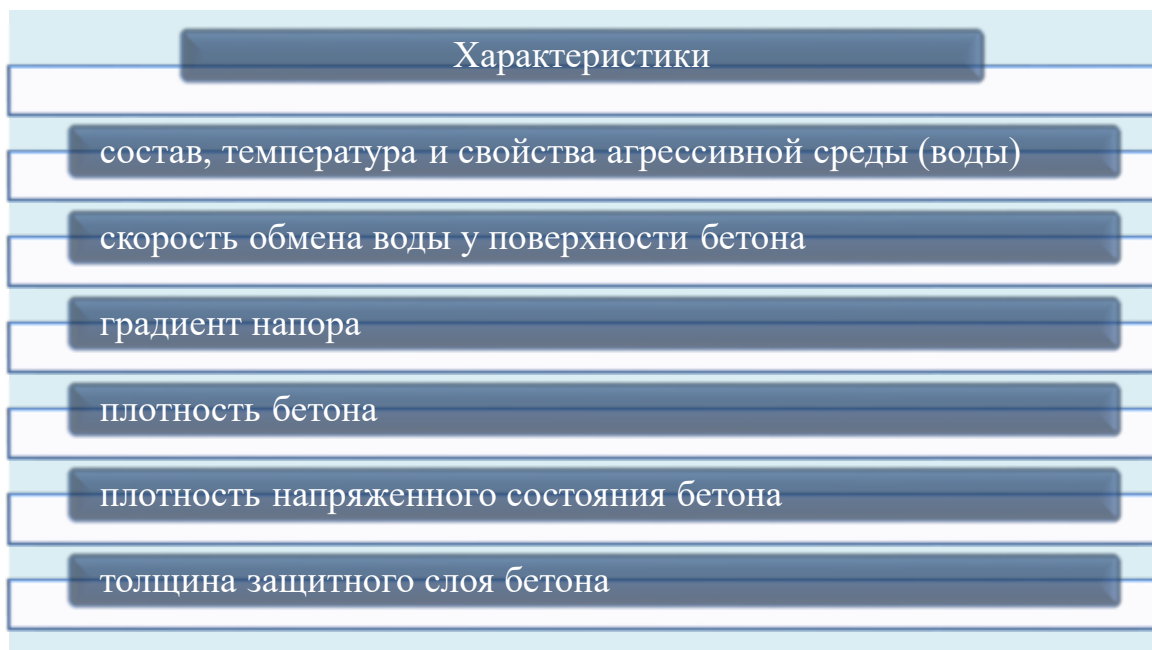
Рисунок 2.20 – Характеристики среды и бетонных и железобетонных сооружений, влияющие на возникновение и развитие коррозии
