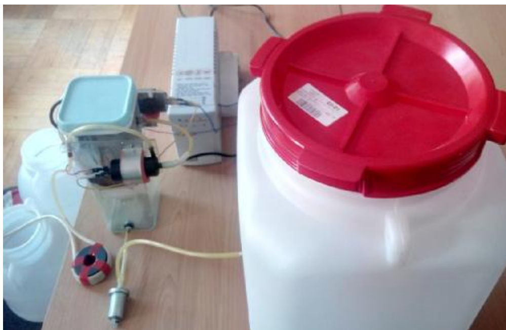
Рисунок 2.1 – Внешний вид лабораторного образца установки для электрохимической активации воды
