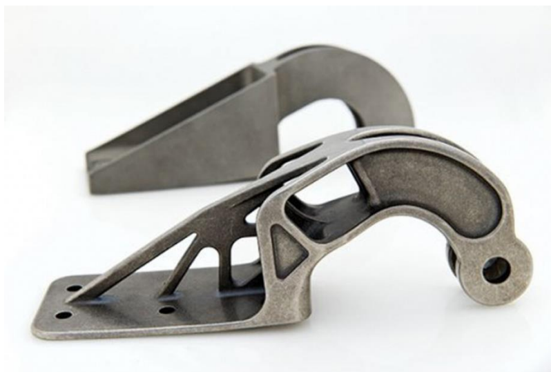
Рис. 3 Два варианта петли для кожухов двигателей Airbus A380. На переднем плане — бионический вариант, изготовленный методом металлической 3D-печати
