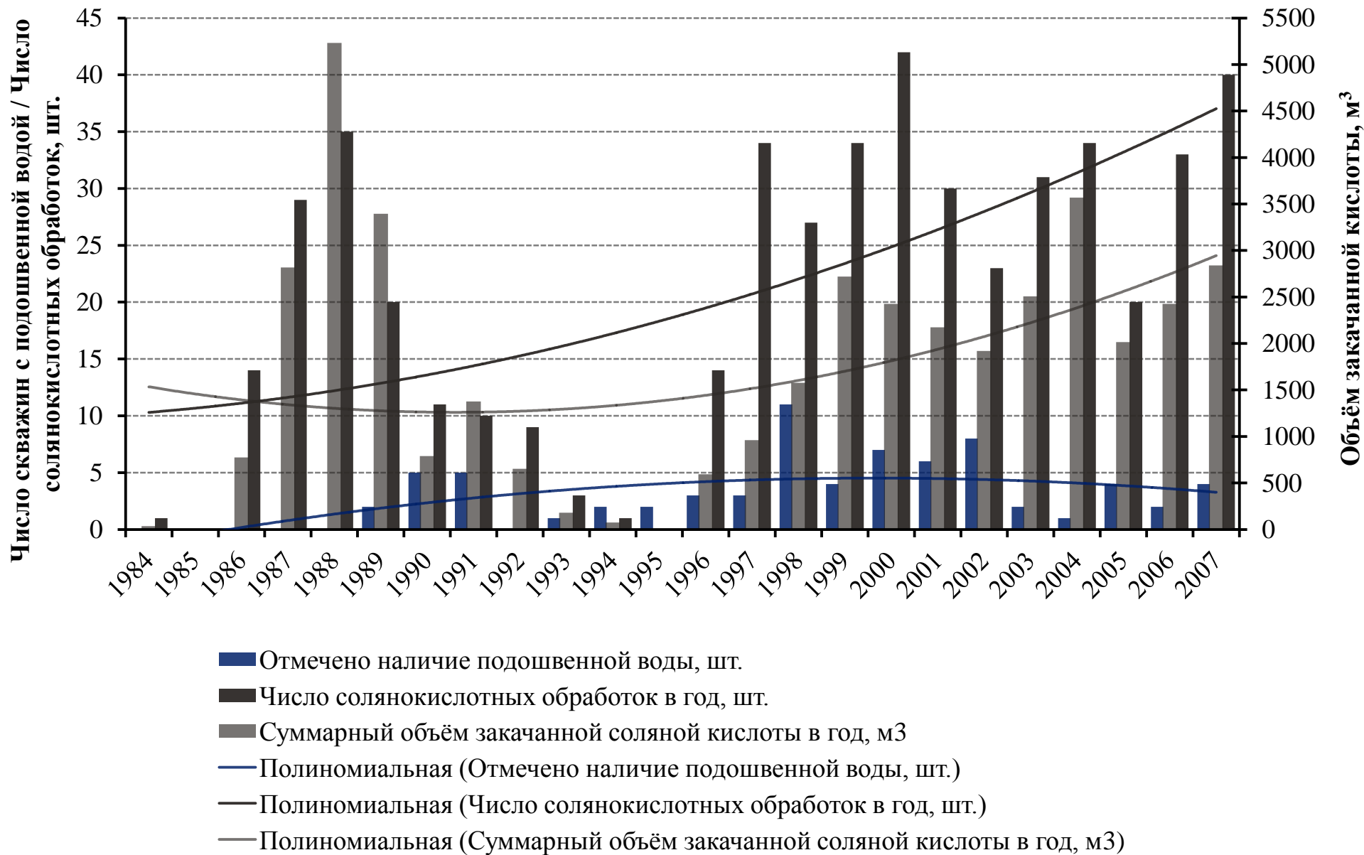
Рисунок 15 - Годовая динамика скважин АГКМ с появившейся подошвенной водой и солянокислотных обработок [10]
