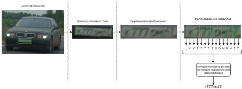
Рис.3.4.1. Архитектура системы детектирования и распознавания номерных знаков
