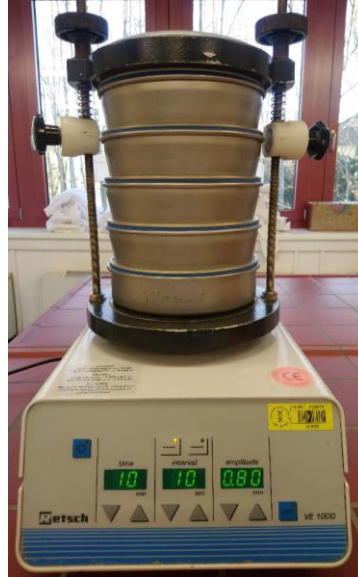
Рисунок 2.1 – Проведение испытания ситовым методом
