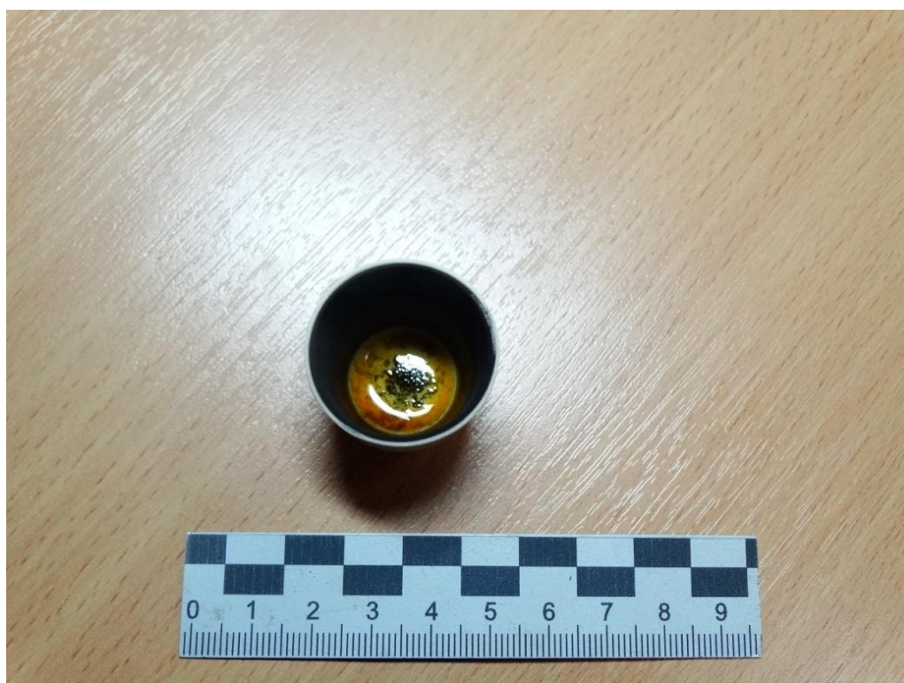
Фото № 18. Вид сильно выгоревшей (на 99 % по масс.) жидкости из канистры (объект исследования № 3)
