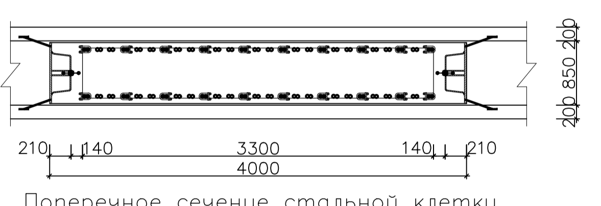
Поперечное сечение стальной клетки
