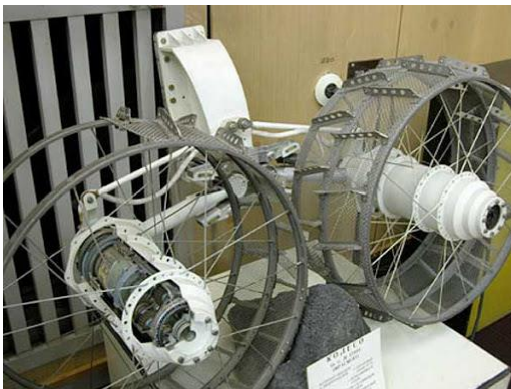
Рисунок 2 – Блок колёсных движителей с подвеской [11]
