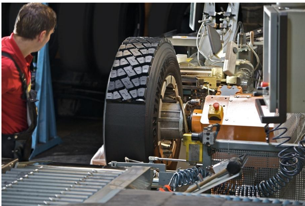
Рисунок 4 – Процесс восстановления протектора автомобильной шины
