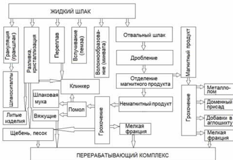
Рисунок 1.1 - Схема переработки доменных шлаков
