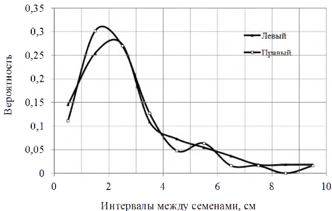
Рисунок 5.13 – Вероятность распределения семян на ленте при скорости высевающего диска 0,033 м/с (скорость ленты 1,07 м/с)
