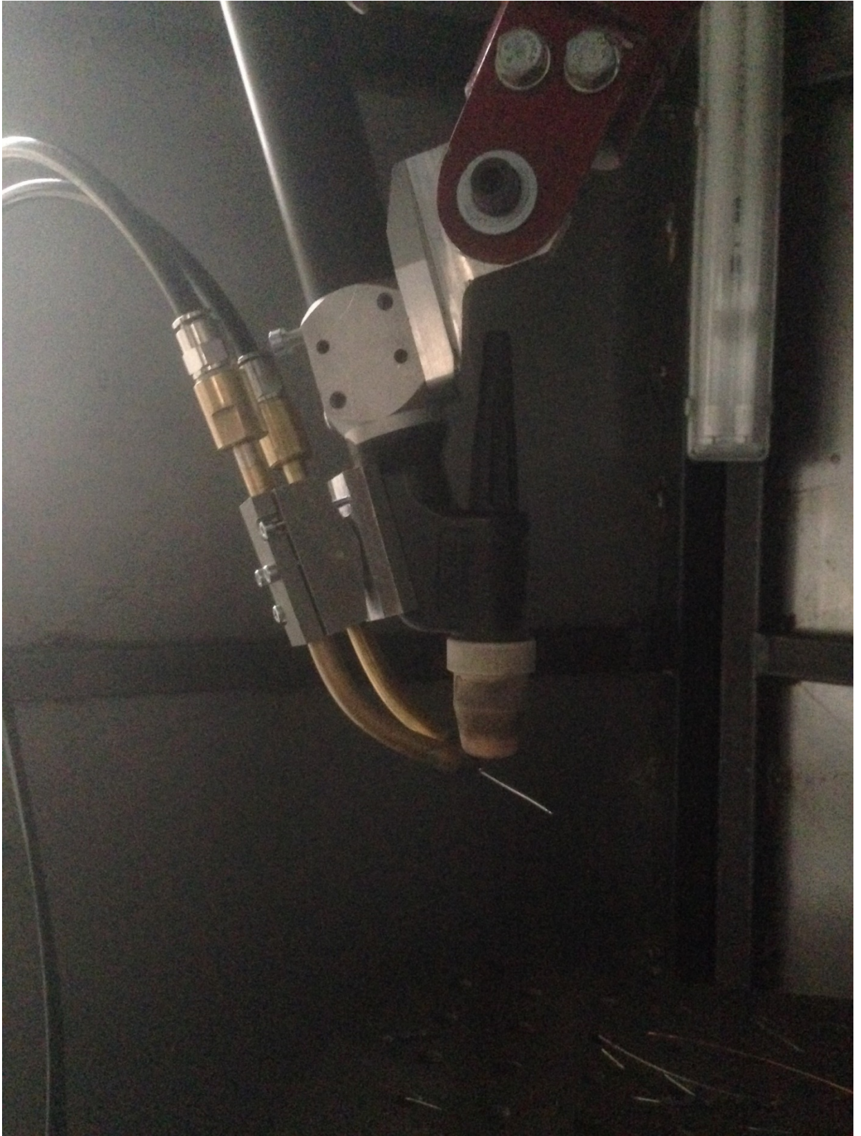
Рис. 2.3. Горелка с наконечниками подающего механизма
