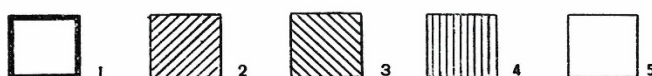
Рисунок 1.1б. Взаимодействие \gamma -железа с элементами периодической системы: 1, 2, 3, 4 – элементы, образующие соответственно непрерывные твёрдые растворы, ограниченные твёрдые растворы, соединения, эвтектические смеси; 5 – не взаимодействующие элементы [15]
