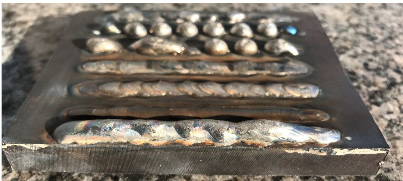
Рисунок 2.7. Экспериментальный многослойный наплавленный валик
