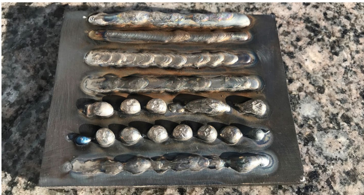
Рисунок 2.6. Последующие экспериментальные наплавки с более тонкой настройкой параметров режима наплавки
