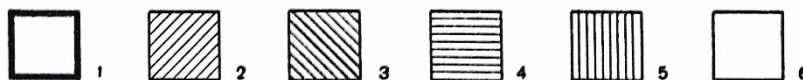
Рисунок 1.2. Взаимодействие алюминия с элементами периодической системы: 1, 2, 3, 4 – элементы, образующие соответственно непрерывные твёрдые растворы, ограниченные твёрдые растворы, соединения, эвтектические смеси; 5 – не взаимодействующие элементы; 6 – неизученные элементы [15]
