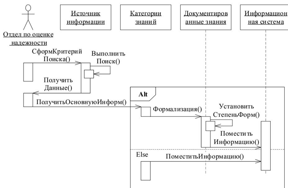
Рис. 4. Модель временного взаимодействия экземпляров классов, представленная с помощью UML диаграммы последовательности
