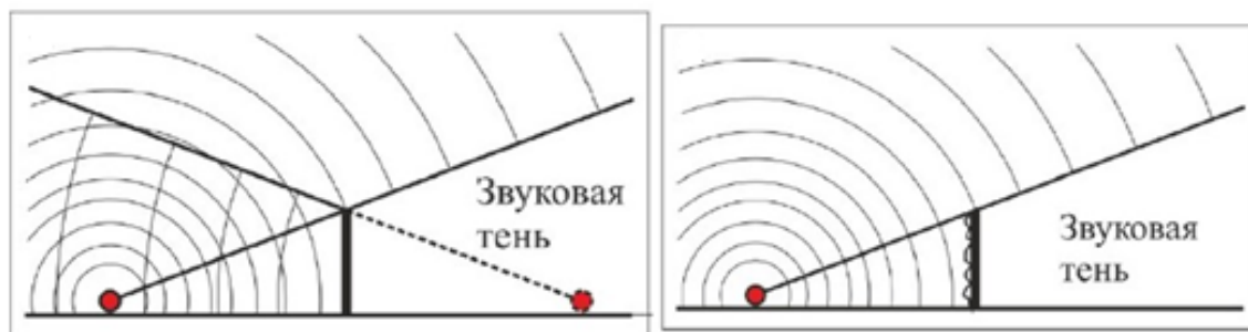
Рис.2. Схема работы шумозащитного экрана:
