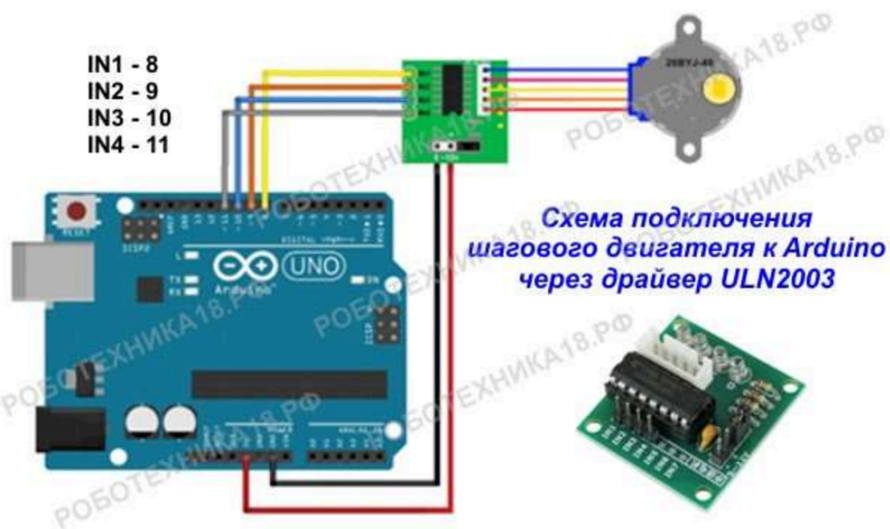
Рисунок 15. Схема подключения шагового двигателя на «Arduino»
